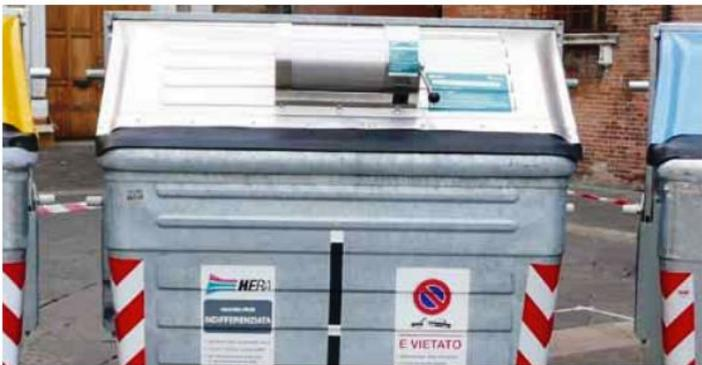
Cassonetto dotato di sistema eGate, con calotta per l'introduzione controllata dei rifiuti e sistema di riconoscimento dell'utente, in uso nel territorio riminese
