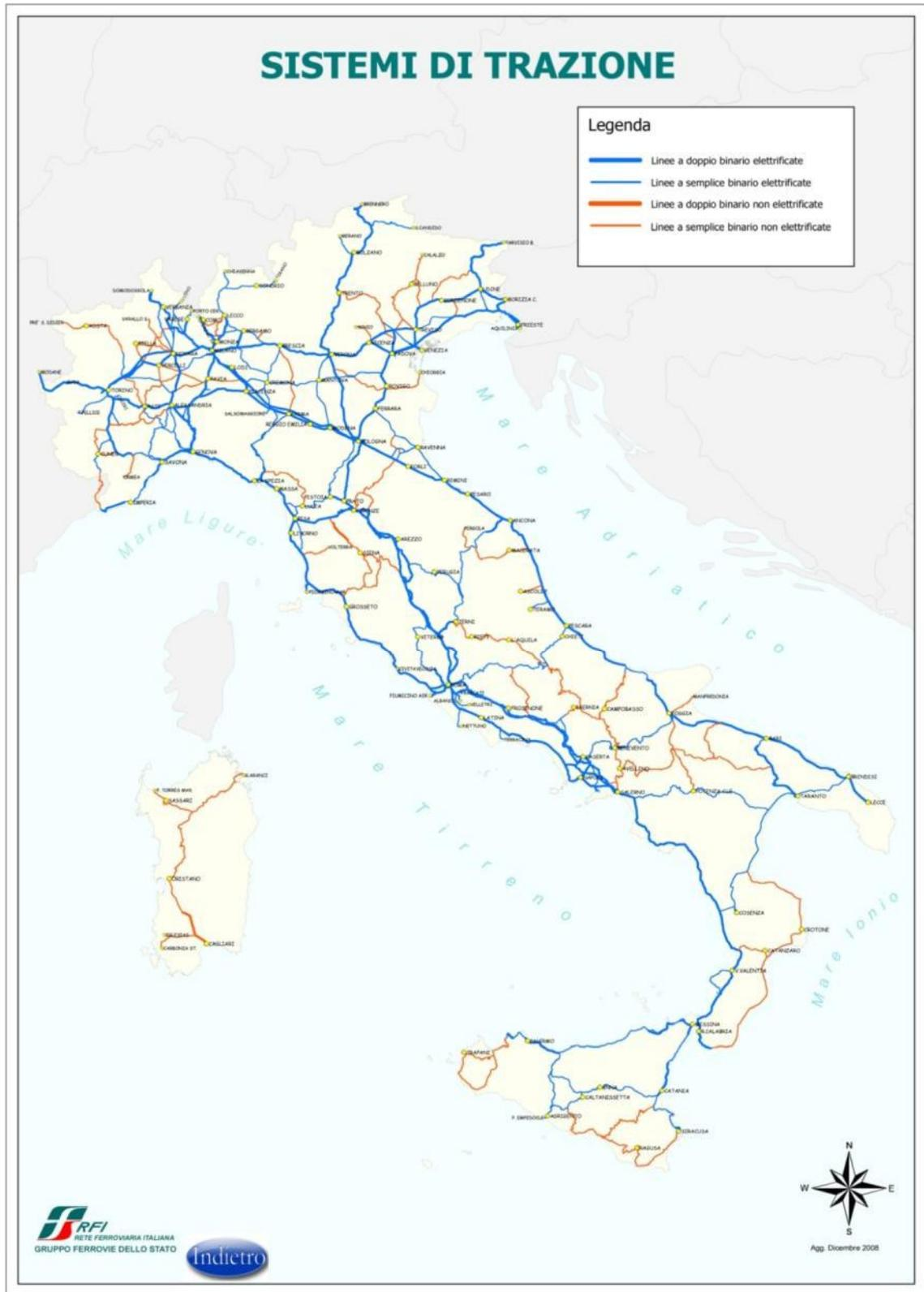
**Figura 27: Rete ferroviaria Ferrovie dello Stato (fonte: RFI)**
